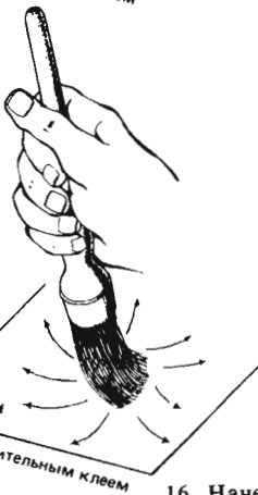
16. Нанесение животного (наверху) и растительного (внизу) клея
